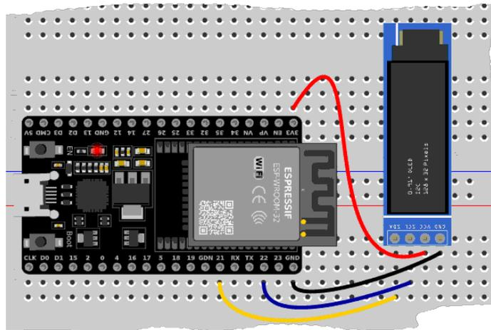
Figure 23: branchement de l'afficheur OLED SSD1306 I2C
