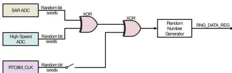
Lorsqu'il y a du bruit provenant du SAR ADC, le générateur de nombres aléatoires est alimenté avec une entropie de 2 bits dans un cycle d'horloge de RTC8M\_CLK (8 MHz), qui est généré à partir d'un oscillateur RC interne (voir le chapitre Réinitialisation et Horloge pour plus de détails). Ainsi, il est conseillé de lire le registre **RNG\_DATA\_REG** à une cadence maximum de 500 kHz pour obtenir l'entropie maximale.
