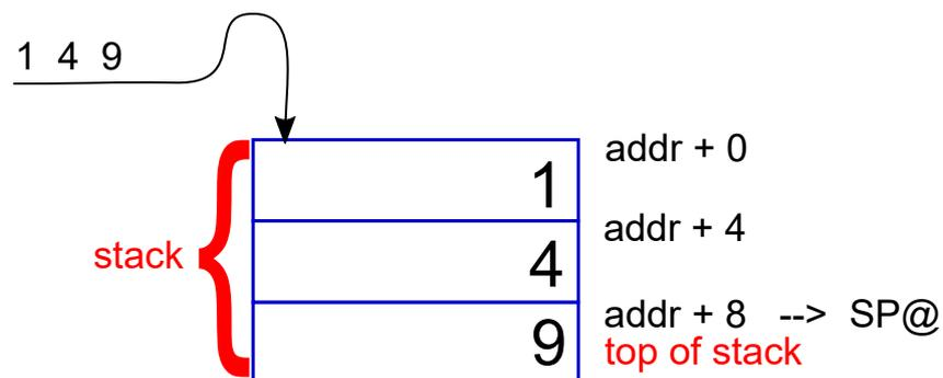
Ici, on a empilé trois valeurs, **1**, **4** et **9**. A chaque empilement, le pointeur de pile est incrémenté automatiquement. En assembleur Xtensa, le pointeur de pile se retrouve dans le registre a2. Nous avons vu, que nous pouvons manipuler le contenu de ce registre avec les macro-instructions **sp++**, et **sp--**. La manipulation de ce registre a une action directe sur le pointeur de pile géré par ESP32forth.
