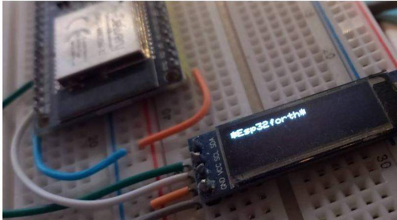
Figure 26: résultat de l'exécution du mot `Oled128x32Init`
