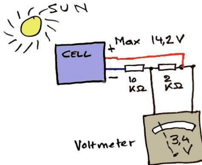
La mesure de tension est relevée entre les deux résistances et la borne positive du panneau solaire.
