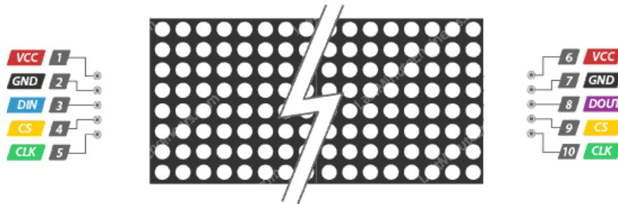
Figure 30: connecteurs SPI sur le module MAX7219
