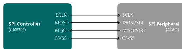
Figure 27: commande d'un périphérique SPI
