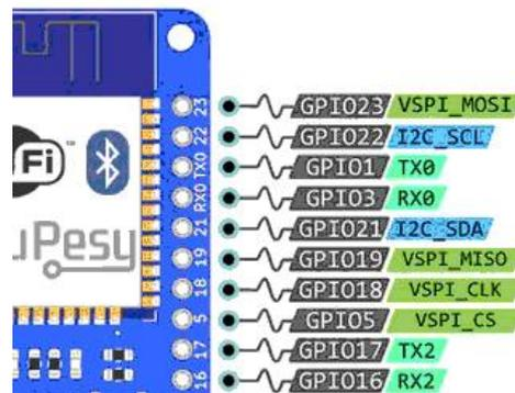
Figure 29: les deux ports SPI sur la carte ESP32
