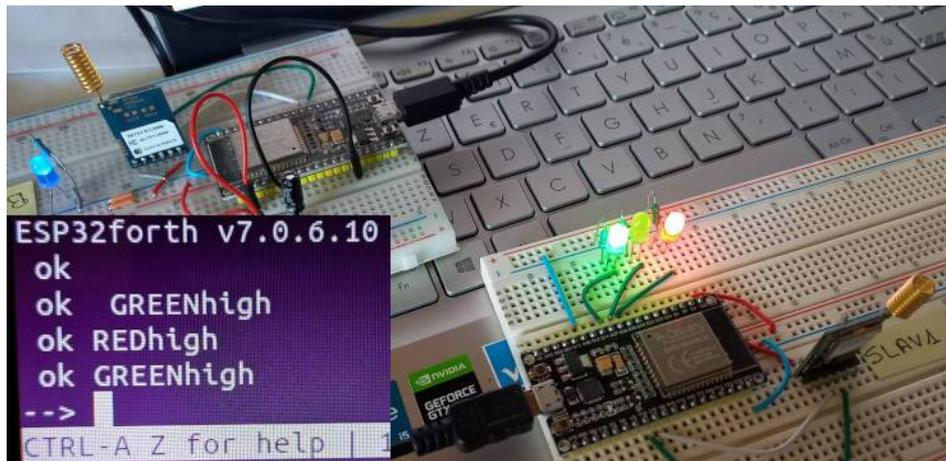
Sur la carte marquée **SLAV1**, Les LEDs réagissent avec une latence de une à deux secondes. Ce délai est normal. Il résulte du protocole LoRa qui est certes lent, mais extrêmement robuste. Sur la photo ci-dessus, les tests ont été effectués avec une distance de un mètre. Les cartes **BOSS** et **SLAV1** ont été rapprochées pour la photo.
