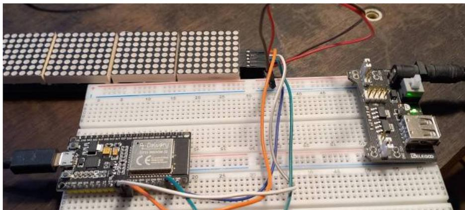
Figure 31: utilisation d'une alimentation extérieure
