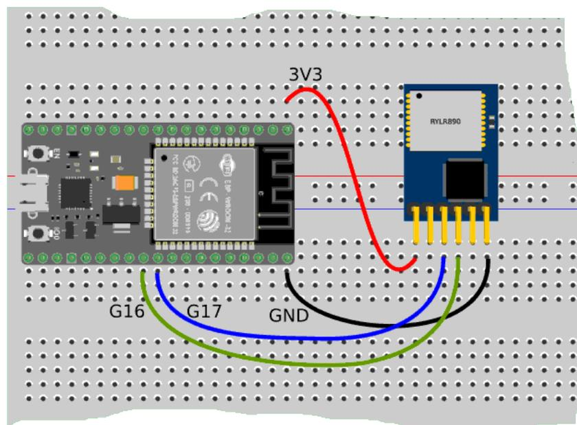
Figure 36: branchement du transmetteur LoRa
