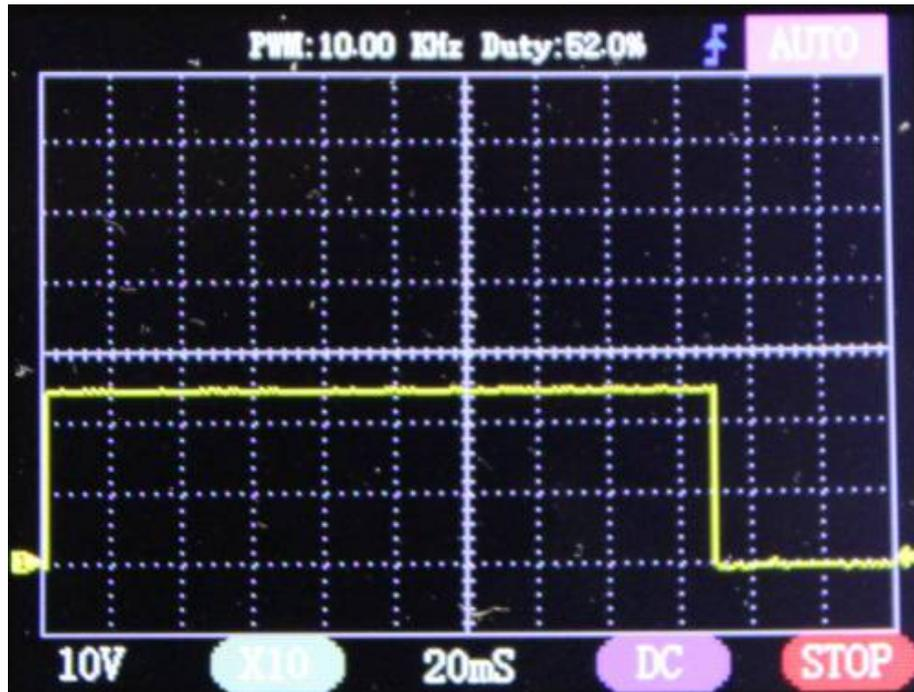
Sur cette capture de signal, le niveau bas sur la borne G15 apparaît quand on manœuvre la tige de commande de l'encodeur. Au repos, le signal sur la borne G15 est au niveau haut.
