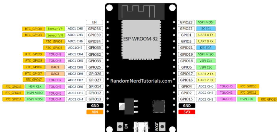
Nous allons en utiliser un, le canal **ADC1\_CH6** qui est rattaché au pin **G34** :
