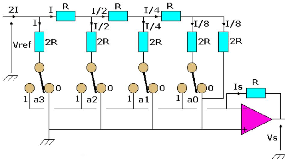
La valeur à convertir, sur 4 bits, est répartie sur 4 pins  $a_0$  à  $a_3$ . La tension de référence est injectée en haut à gauche du circuit. Cette tension génère une intensité  $2I$  si ce courant ne traverse aucune résistance.
