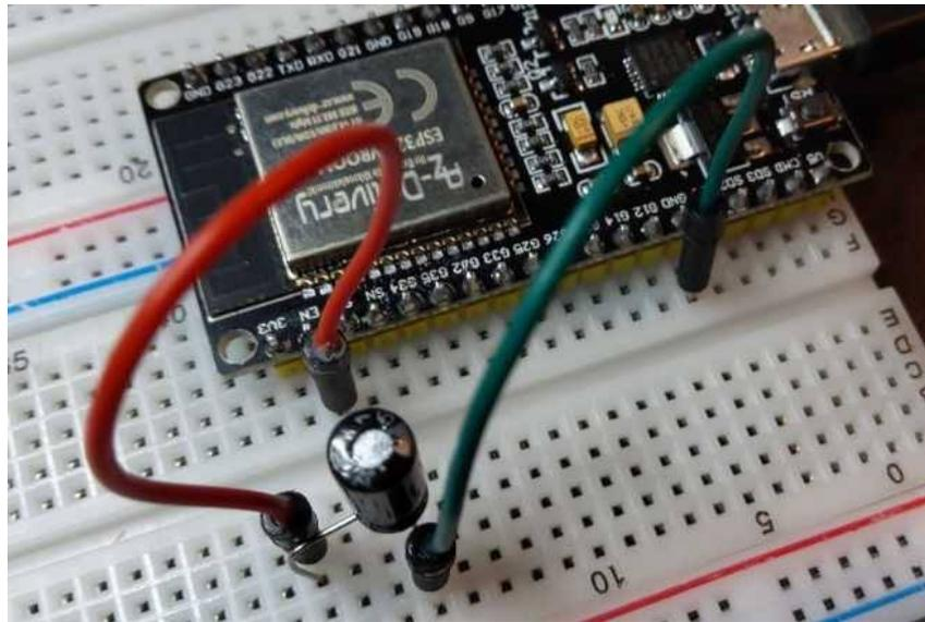
Cette manipulation n'est nécessaire que si vous êtes dans la phase de téléversement de ESP32forth depuis ARDUINO IDE. Une fois ESP32forth installé sur la carte ESP32, l'utilisation de ce condensateur n'est plus nécessaire.
