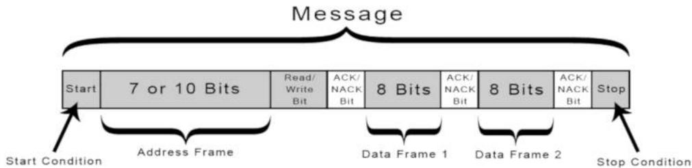
**Condition de démarrage:** la ligne SDA passe d'un niveau de tension élevé à un niveau de tension bas avant que la ligne SCL ne passe de haut en bas.
