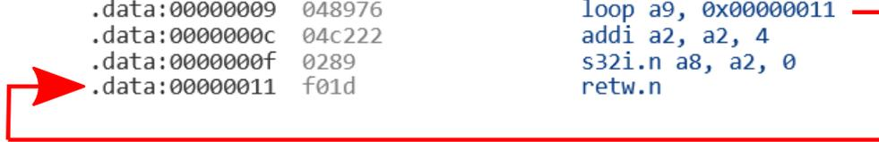
Le désassembler indique une adresse de branchement. En réalité, le code assemblé ne contient que cet offset indiqué par le label sous forme de valeur positive 8 bits.
