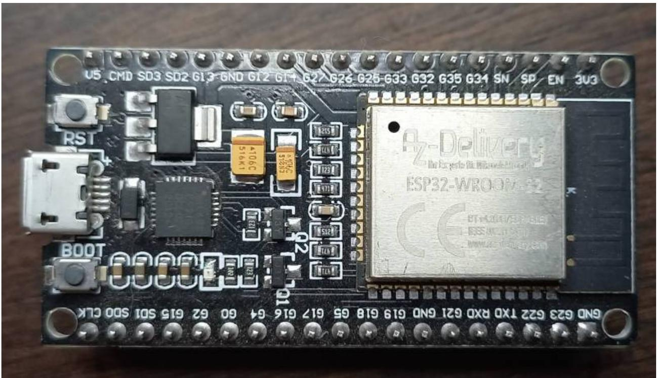
La posición y la cantidad de E/S GPIO pueden cambiar según la marca de la tarjeta. Si este es el caso, sólo son auténticas las indicaciones que aparecen en el mapa físico. En la foto, fila inferior, de izquierda a derecha : CLK, SD0, SD1, G15, G2, G0, G4, G16.....G22, G23, GND.
