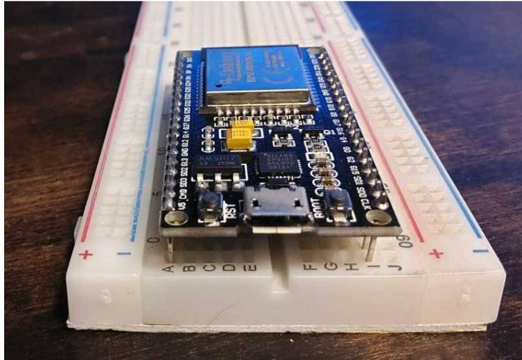
No existe una placa de pruebas específicamente adaptada a las placas ESP32.
