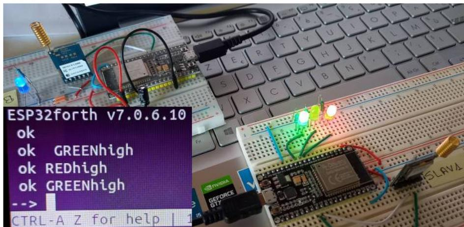
En la tarjeta marcada **SLAV1** , los LED reaccionan con una latencia de uno a dos segundos. Este retraso es normal. Resulta del protocolo LoRa, que es ciertamente lento, pero extremadamente robusto. En la foto de arriba, las pruebas se realizaron a una distancia de un metro. Para la foto se juntaron las tarjetas **BOSS** y **SLAV1** .
