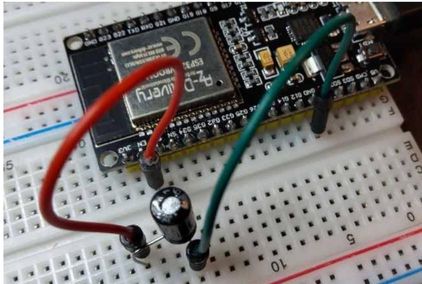
Diese Manipulation ist nur erforderlich, wenn Sie sich in der Hochladephase von ESP32forth von der ARDUINO IDE befinden. Sobald ESP32forth auf der ESP32-Platine installiert ist, ist die Verwendung dieses Kondensators nicht mehr notwendig.
