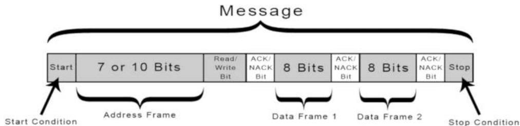
**Startbedingung** : Die SDA-Leitung wechselt von einem hohen Spannungspegel auf einen niedrigen Spannungspegel, bevor die SCL-Leitung von hoch auf niedrig wechselt.
