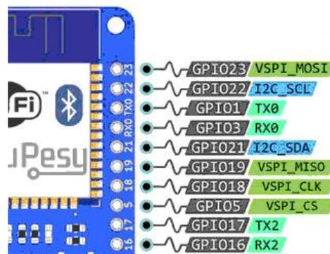
Figure 24: die beiden SPI-Ports auf der ESP32-Karte
