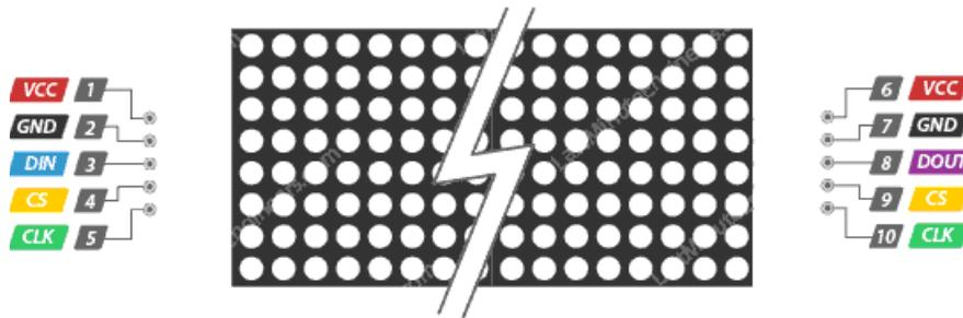
Figure 25: SPI-Anschlüsse am MAX7219-Modul
