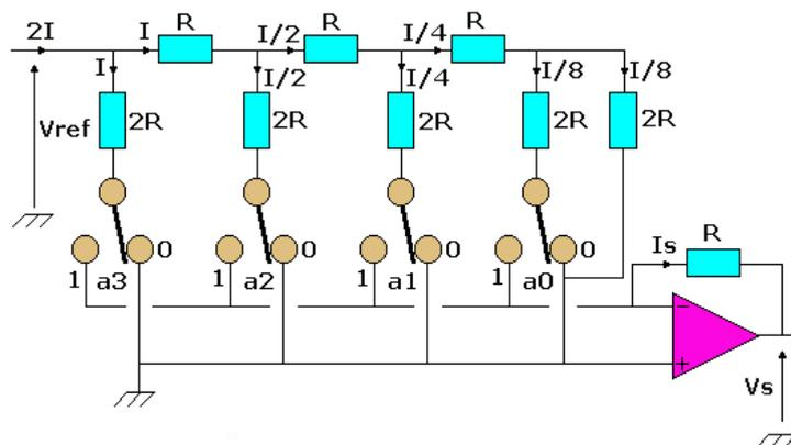
Der zu konvertierende Wert wird auf 4 Bits auf die 4 Pins a0 bis a3 verteilt. Die Referenzspannung wird oben links in die Schaltung eingespeist. Diese Spannung erzeugt eine Intensität von  $2I$ , wenn dieser Strom keinen Widerstand durchfließt.
