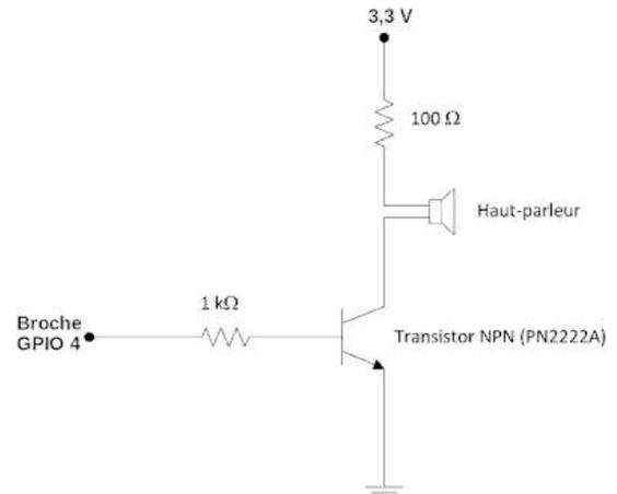
Figure 27: Anschließen eines Lautsprechers
