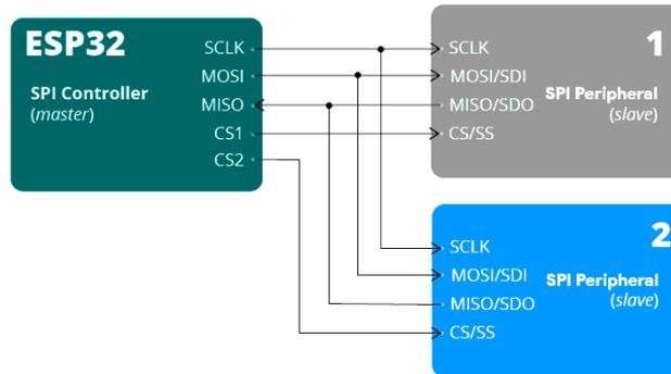
Figure 23: Steuerung von zwei SPI-Geräten
