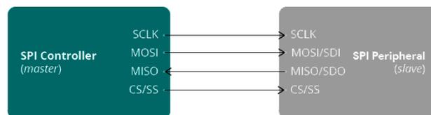
Figure 22: Steuern eines SPI-Geräts
