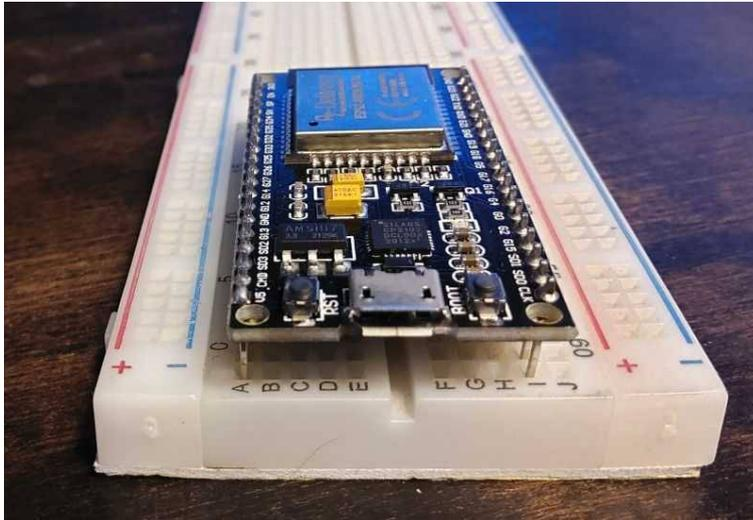
Es gibt kein Steckbrett, das speziell für ESP32-Boards geeignet ist.
