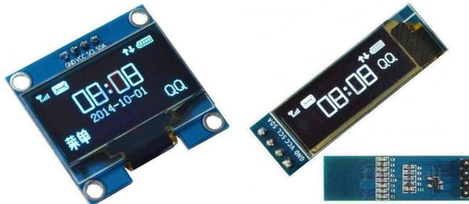
Diese Displays sind mit SPI- oder I2C-Schnittstelle verfügbar.
