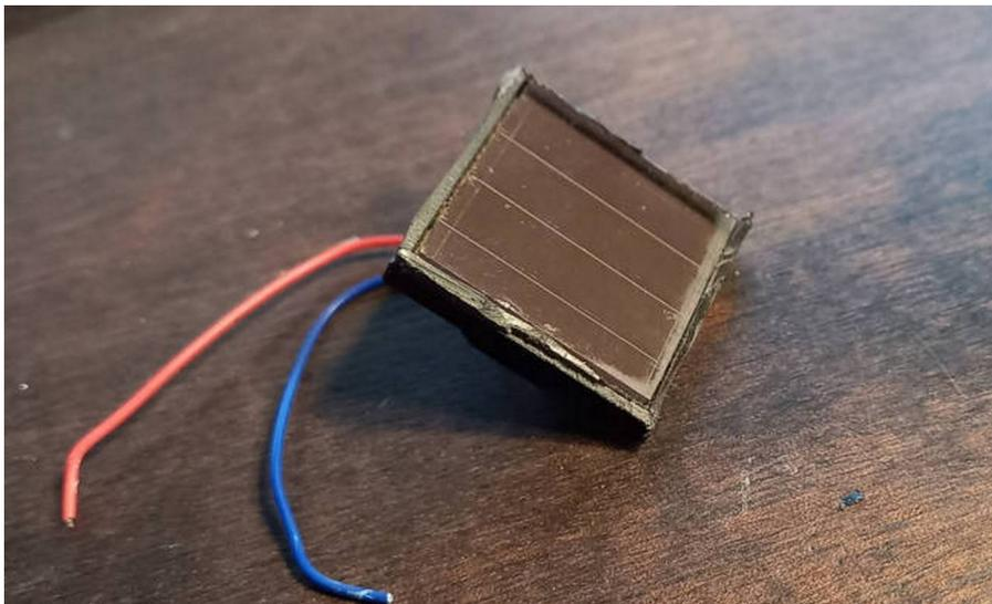
Wir opfern zwei Dupont-Anschlüsse, um verschiedene Messungen an unserer Prototypenplatte durchführen zu können. Diese Anschlüsse werden an die beiden roten und blauen Drähte angelötet, die aus dem Mini-Solarpanel kommen.
