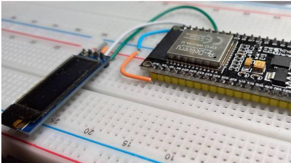
Figure 17: An den I2C-Bus angeschlossenes OLED-Display
