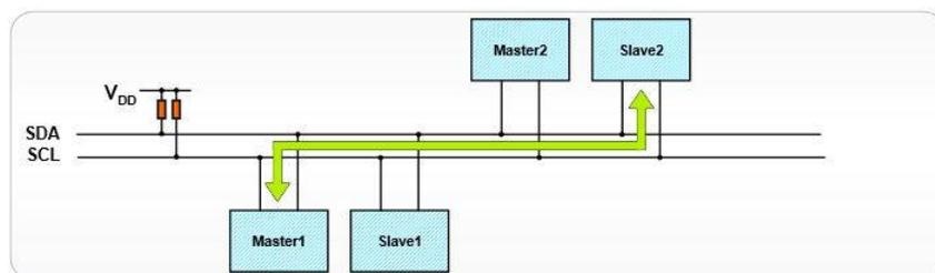
Figure 16: Prinzip eines I2C-Busses
