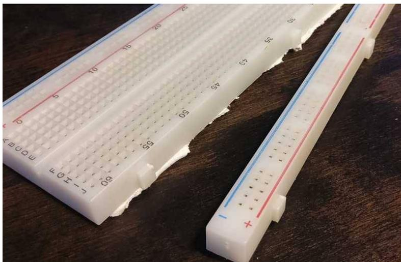
Mit dieser Karte können wir dann die gesamte Karte wieder zusammensetzen. An den Seiten der Testplatten befinden sich Sparren, um diese miteinander zu verbinden:
