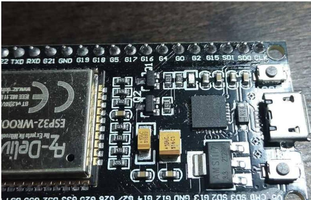
Jeder Anschluss ist durch eine Reihe von Buchstaben und Zahlen gekennzeichnet, hier von links nach rechts auf unserem Foto: G22 TXD RXD G21 GND G19 G18 usw.
