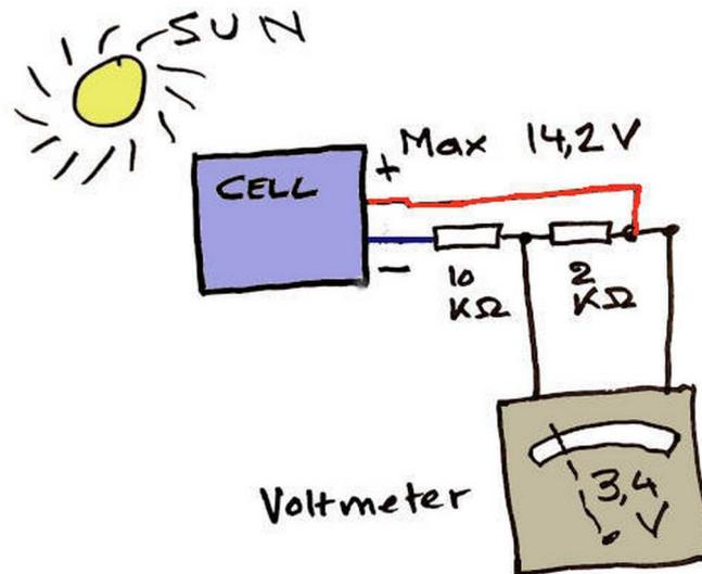
Die Spannungsmessung erfolgt zwischen den beiden Widerständen und dem Pluspol des Solarpanels.
