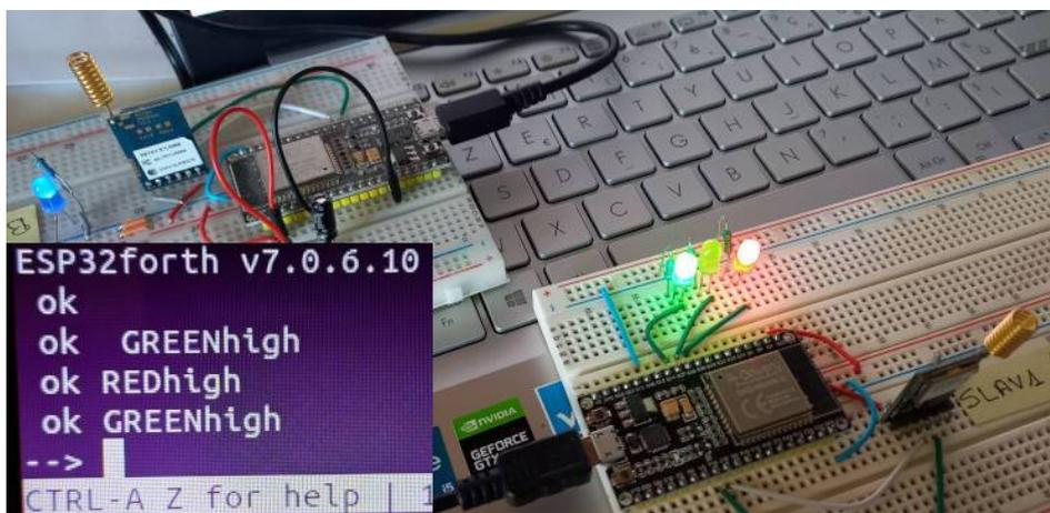
Auf der mit **SLAV1** gekennzeichneten Karte reagieren die LEDs mit einer Latenz von ein bis zwei Sekunden. Diese Verzögerung ist normal. Dies resultiert aus dem LoRa-Protokoll, das zwar langsam, aber äußerst robust ist. Auf dem Foto oben wurden die Tests mit einem Abstand von einem Meter durchgeführt. Für das Foto wurden die **BOSS-** und **SLAV1-** Karten zusammengebracht.
