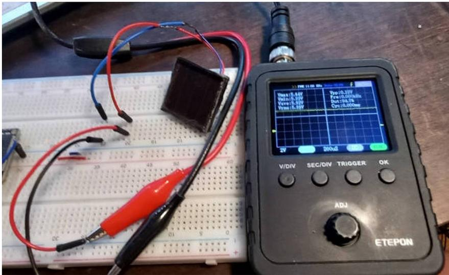
Bei hellem Licht beträgt die gemessene Spannung 14,2 Volt!
