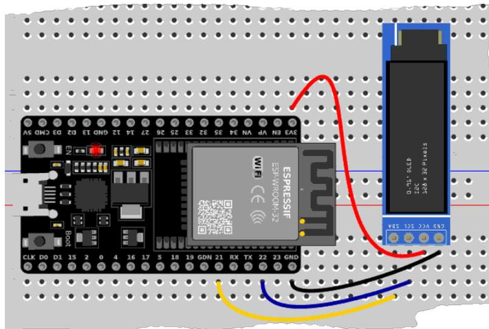
Figure 18: branchement de l'afficheur OLED SSD1306
